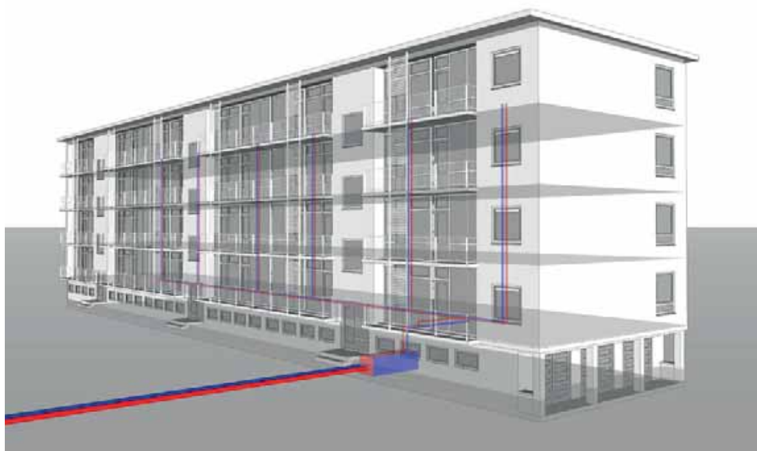
Complex 2 - aansluitschema 24 portiekwoningen uit 1960 in Mariahoeve
