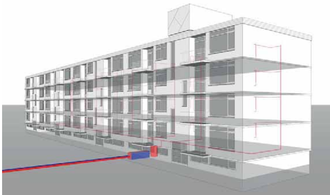
Complex 1 - aansluitschema 32 portiekwoningen uit 1968 in ZuidWest
